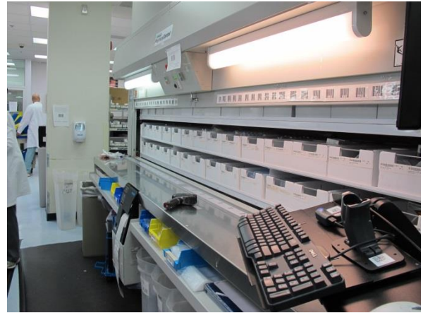
↑ UDD 使用的機器，有 Bar code 系統可以確認藥品拿取無誤。
